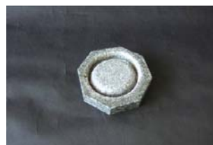
Рис. 1: Образец серого гранита, облученного последовательностью импульсов трубчатого пучка релятивистских электронов
