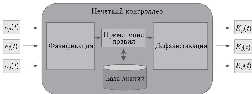
Рис. 1. Схема работы НР: e_p , e_i , e_d — пропорциональная, интегральная и дифференциальная ошибки; K_p , K_i , K_d — коэффициенты классического ПИД-регулятора
