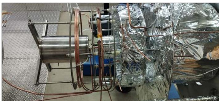
Рис. 3. Сборка гелиевого рефрижератора
