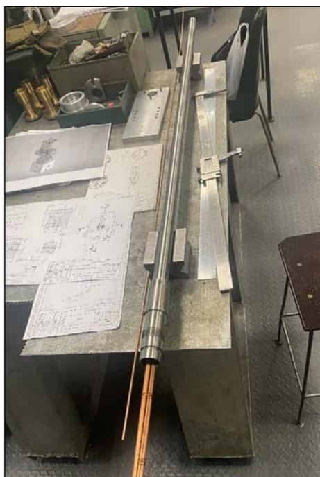
Рис. 6. Сборка узла источника протонов
