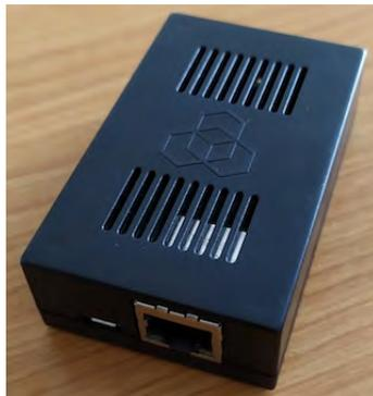
Рисунок 11 — Аппаратный зонд RIPE Atlas - Probe V5
