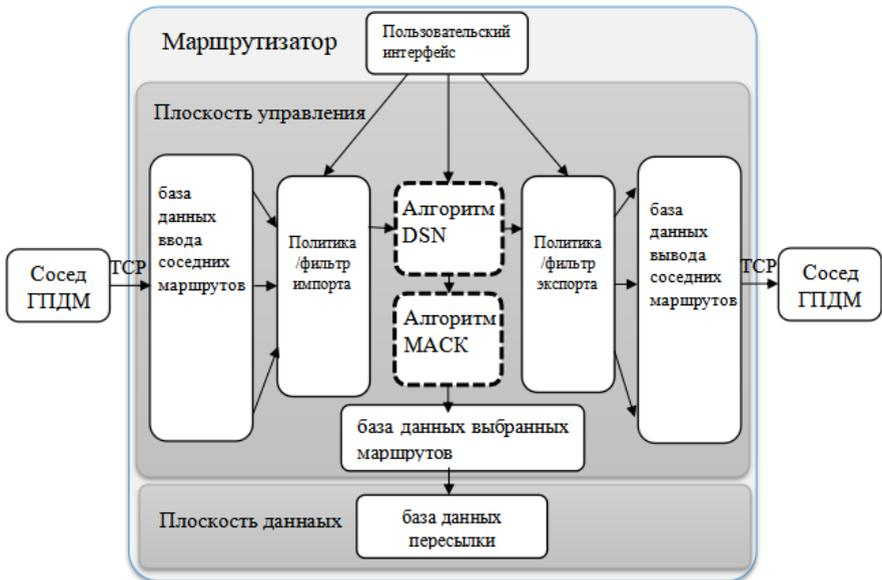
Рис. 2 Архитектура ГПДМ
