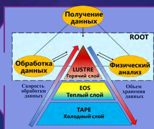
На суперкомпьютере “Говорун” была разработана и внедрена специальная иерархическая система обработки и хранения данных с программно-определенной архитектурой. По скорости доступа к данным различают следующие уровни:
